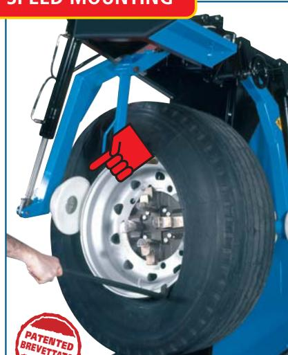
Durante il montaggio il pneumatico è guidato da un utensile brevettato posizionato a 90° rispetto allo stallonatore. Con questo sistema il tallone non può essere tagliato dal cerchio ed è guidato in maniera corretta, senza sforzi eccessivi.
